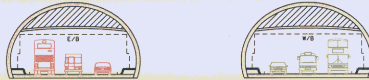
鑽挖式隧道 Bored Tunnels
