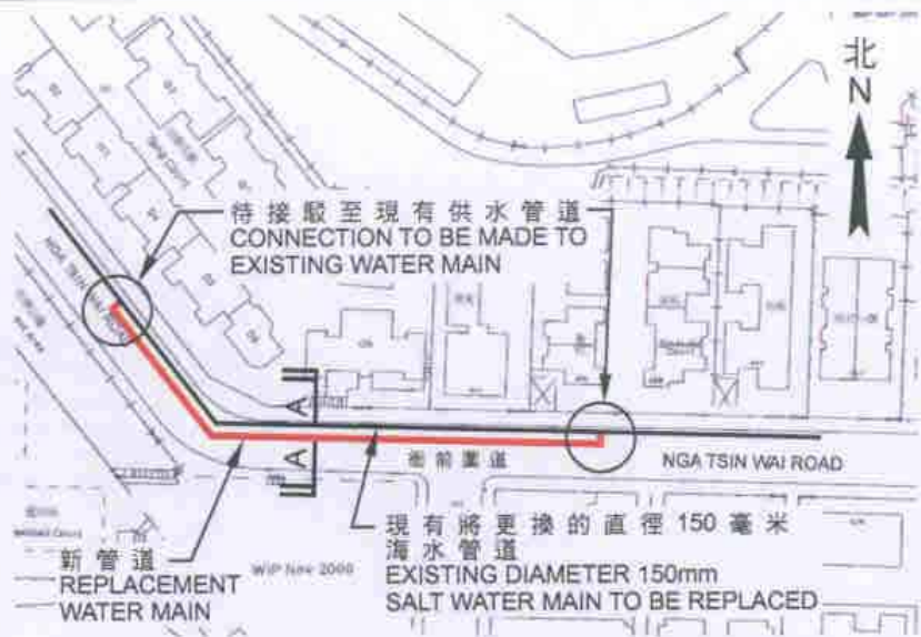
地盤平面圖 - 更換水管 SITE PLAN - WATER MAIN REPLACEMENT 比例尺 SCALE 1:2 000
