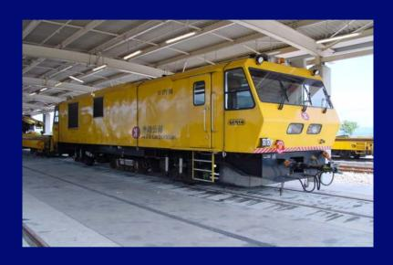
加強採用軌道及架空電綫檢測車 檢查路軌及架空電綫設備至每月 一次
