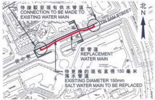
地盤平面圖 - 更換水管
