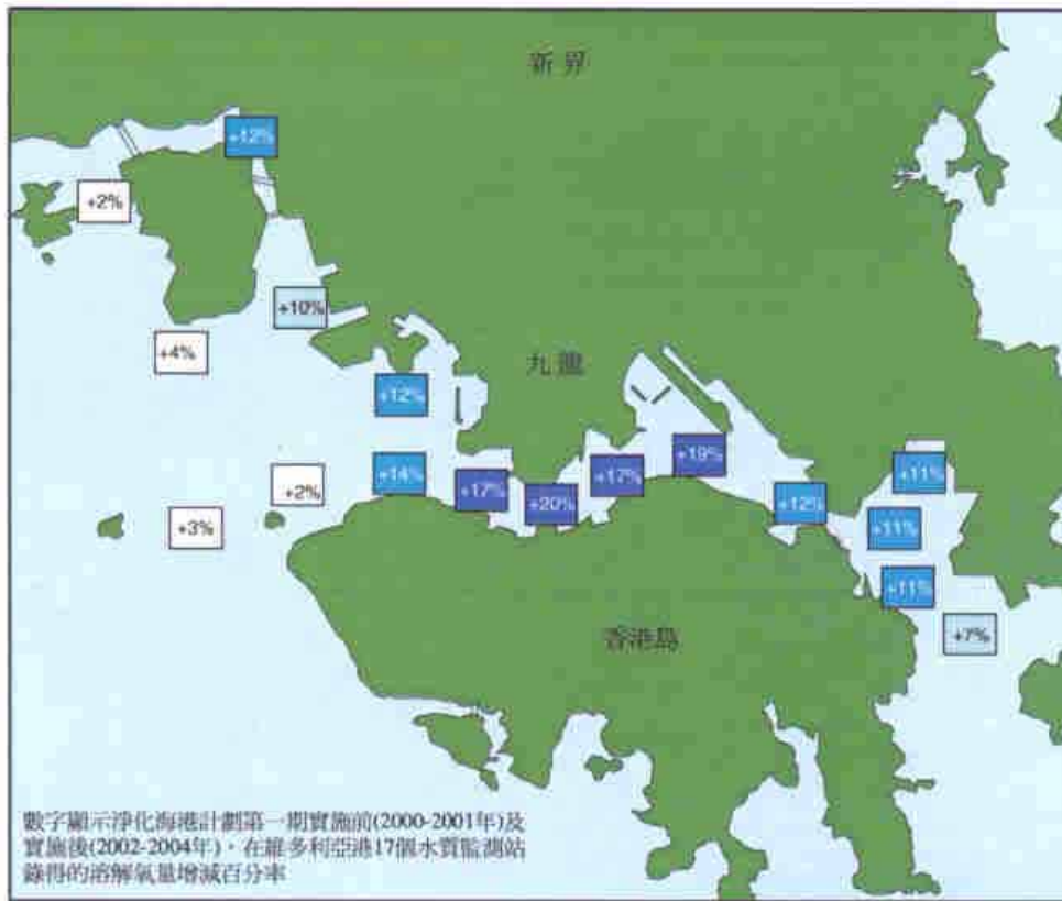
圖 1： 淨化海港計劃第一期實施後錄得的溶解氧量變化
