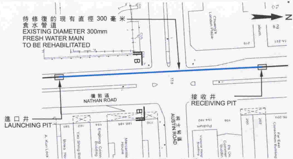
地盤平面圖 - 修復水管 SITE PLAN - WATER MAIN REHABILITATION 比例尺 SCALE 1:1 000
