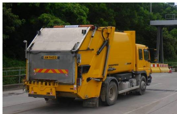
圖 2-食環署使用的密封式垃圾收集車(設有尾蓋)
