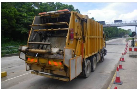
圖 3 - 食環署使用的密封式垃圾收集車(不設尾蓋)
