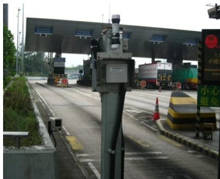
安裝在海關管制站的電子鎖閱讀器
