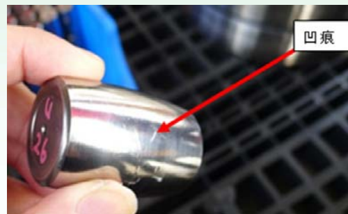
上軸承的頂部滾柱的凹痕
