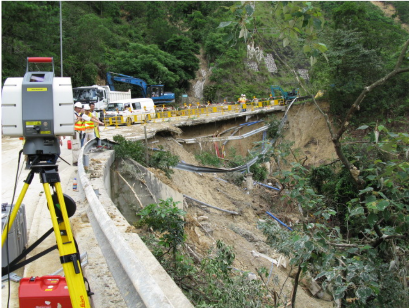
圖 3 激光掃描儀在羗山道進行掃描工作
