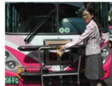
10 推至定位，使車架安全放回原位。
