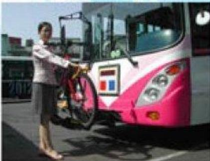
3 將自行車輕輕抬至車架輪溝放置。
