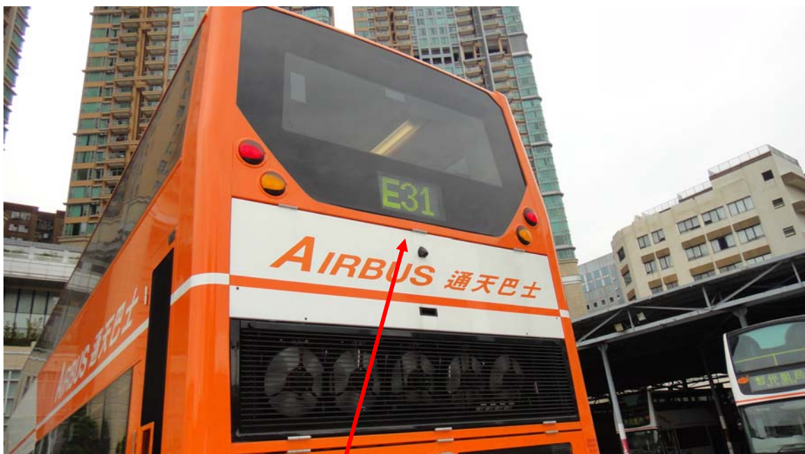
Photograph 16 : Large route number display panel in the rear 相片十六：位於車尾的路線編號大字體顯示屏
