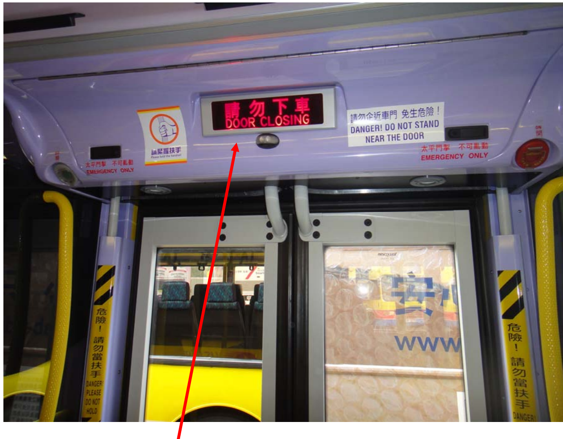
Closing door buzzer & warning lamp 車門關閉蜂鳴器及提示燈
