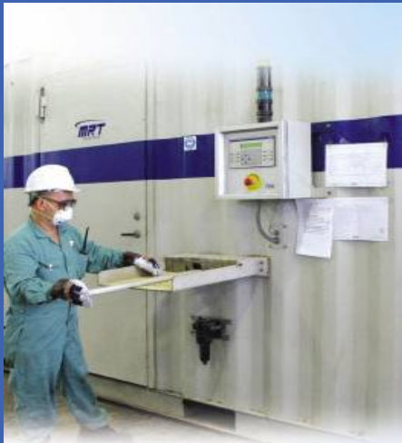
燈管壓碎及分離 處理設備
