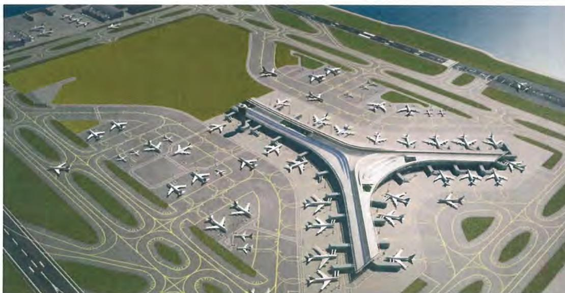
24. 根據IATA Consulting<sup>5</sup>的交通量預測及航空公司的編配策略，為應付每年3,000萬人次客運量及停機位的需求，預計新跑道客運廊停機坪將須提供57個停機位，當中包括34個附設登機橋直接連接客運廊的停機位，以及23個遠方停機位。
