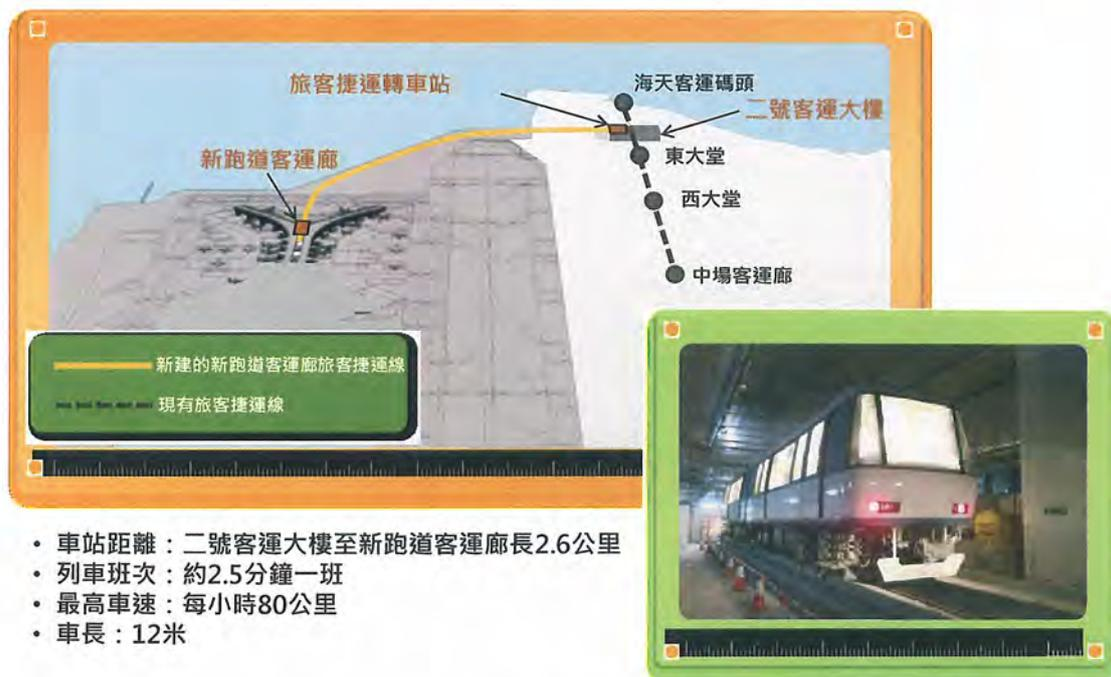
32. 此外，在鄰近旅客捷運轉車站位置將興建新地下旅客捷運系統車廠，為已規劃的新跑道客運廊及現有的旅客捷運系統車隊提供服務，主要包括支援列車維修、列車停放及旅客捷運系統運作管理，並為所有現有及新旅客捷運線設立中央控制設施。
