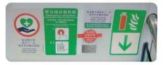
港鐵列車車廂均設有緊急警鐘掣及通話器,以便乘客遇緊急事故時通知列車車長或尋求協助。行走東鐵綫、西鐵綫、馬鞍山綫的列車及輕鐵,車廂內的緊急警鐘掣和通話器上更設有點字板,方便視障乘客使用。
