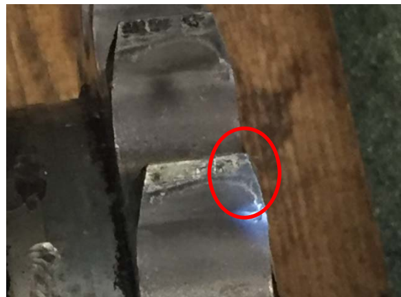
圖 8：顯示電動機鏈輪的齒輪表面磨損的相片
