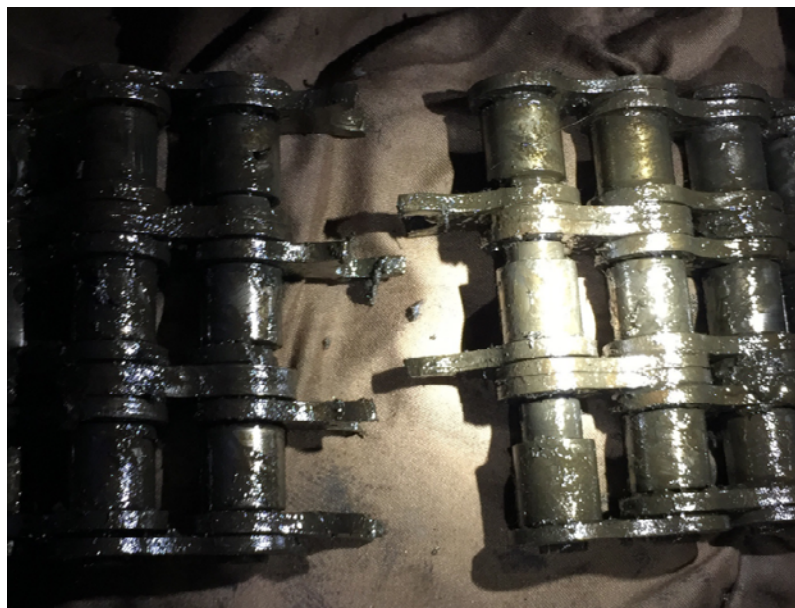
圖 4：顯示主驅動鏈斷裂位置的相片
