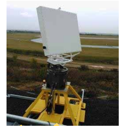
X波段多普勒天氣 雷達感應第三跑 道飛機尾跡渦流 (雨天)
