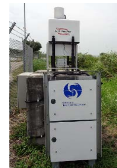
短程激光雷達 探測第三跑道 飛機尾跡渦流
