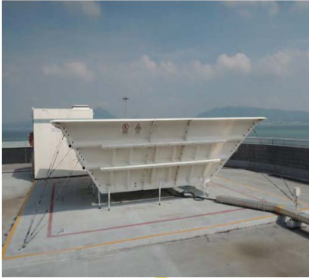
氣流剖析儀探測 第三跑道高空風
