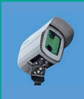
車牌自動識別探測器 16組
