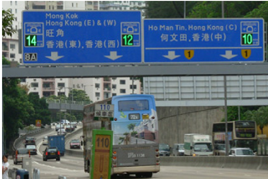
位於窩打老道南行近九龍醫院的行車時間顯示系統 1
