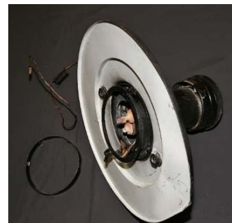
損毀嚴重及被壓至變形煤氣燈頭
