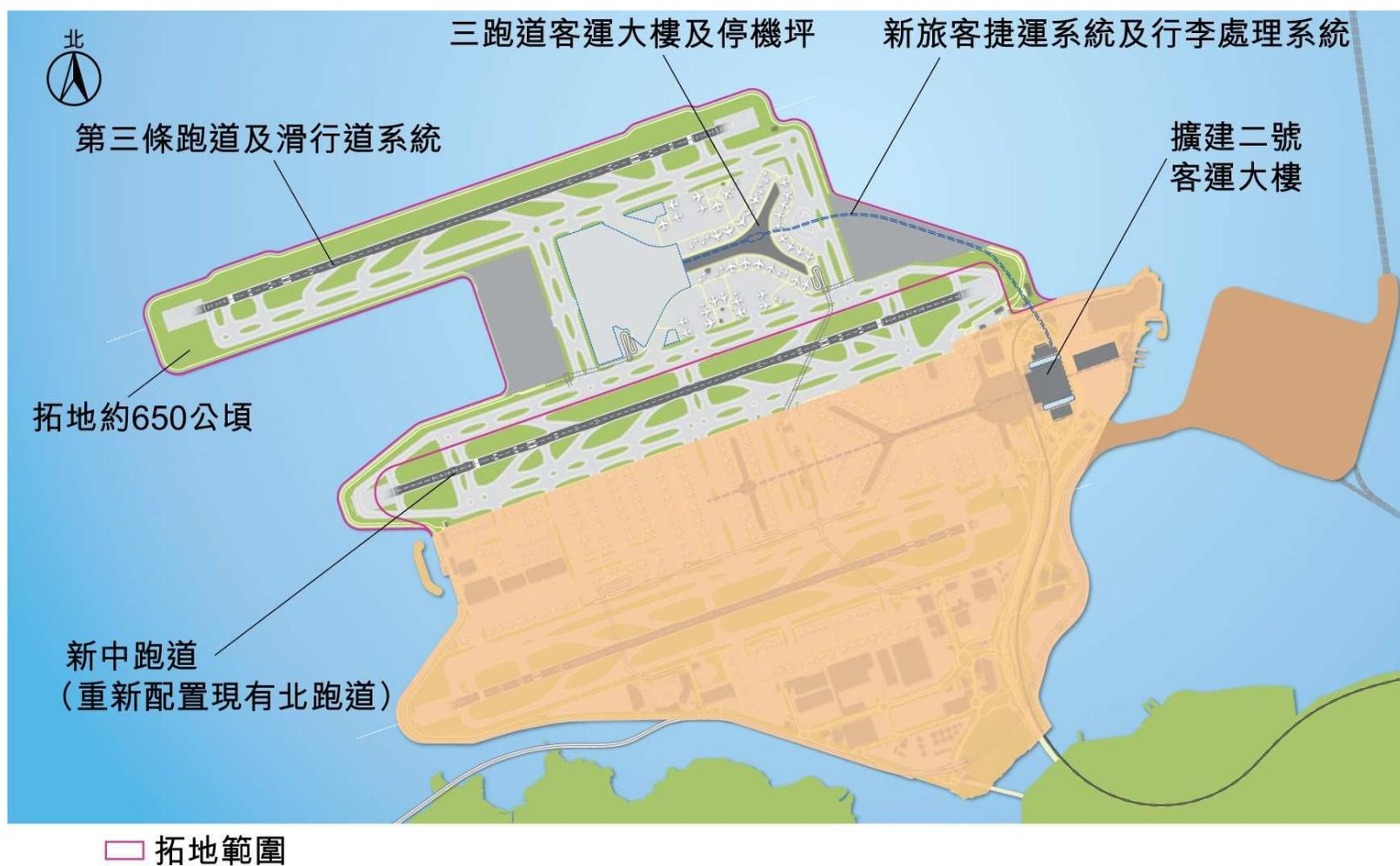
最新的三跑道系統分階段填海計劃
