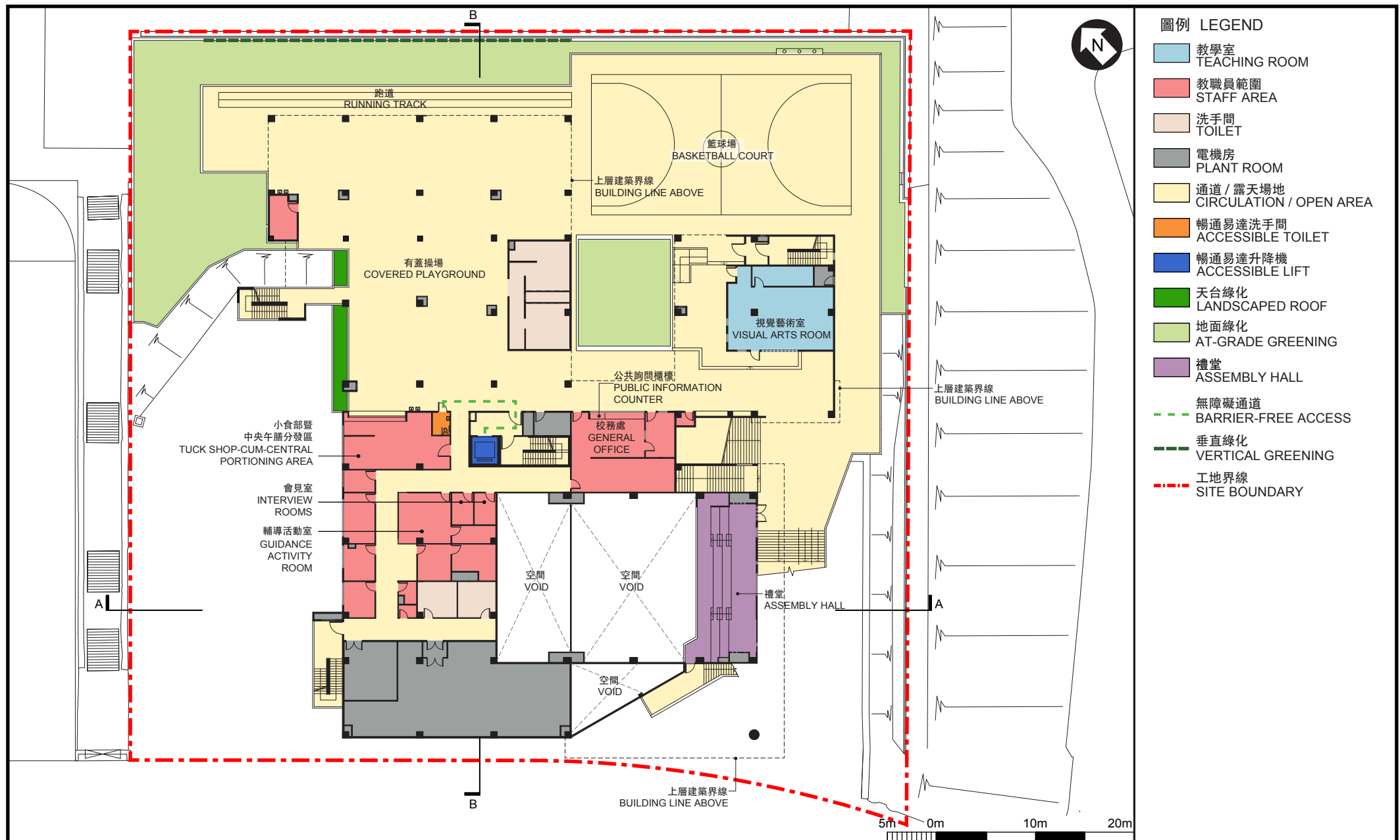
二樓平面圖 SECOND FLOOR PLAN
