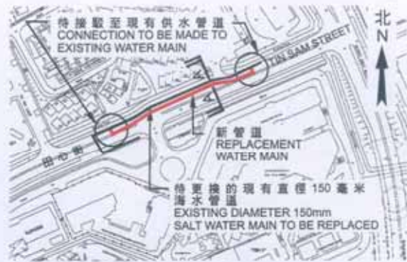
地盤平面圖 - 更換水管 SITE PLAN - WATER MAIN REPLACEMENT 比例尺 SCALE 1 : 2 000
