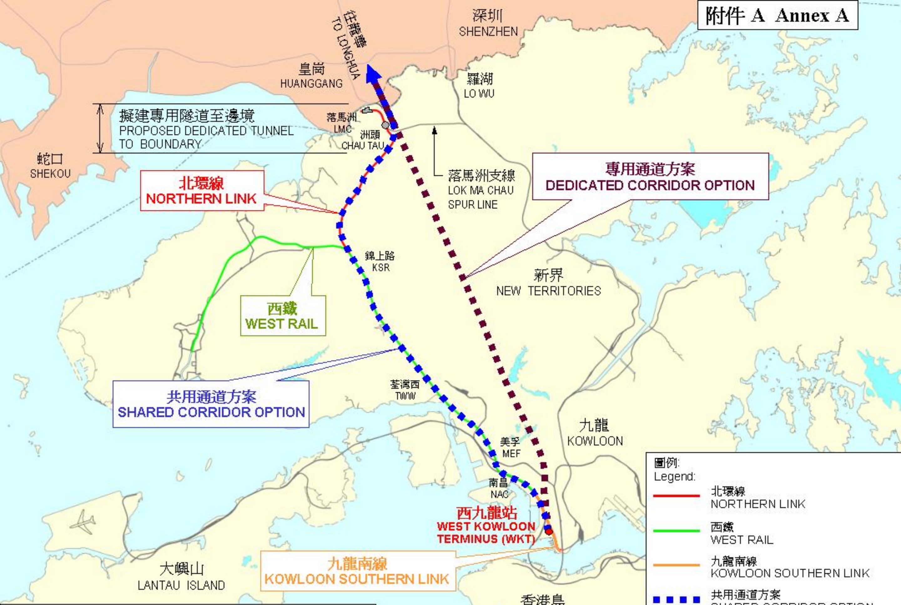
廣深港高速鐵路香港段的線路方案示意圖 ALIGNMENT OF HONG KONG SECTION OF THE ERL
