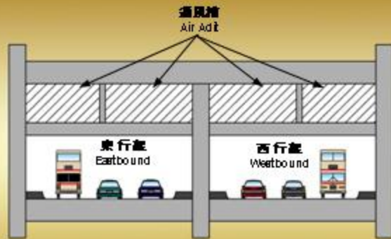
明挖回填式隧道 Cut & Cover Tunnel
