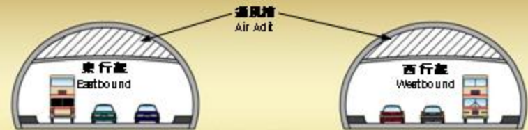
鑽挖式隧道 Bored Tunnels
