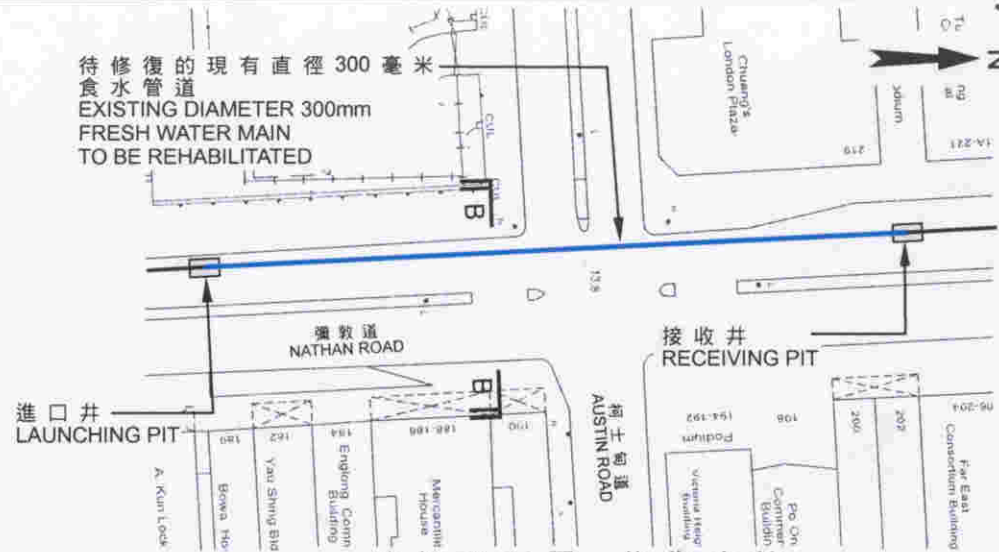
地盤平面圖 - 修復水管 SITE PLAN - WATER MAIN REHABILITATION 比例尺 SCALE 1:1 000
