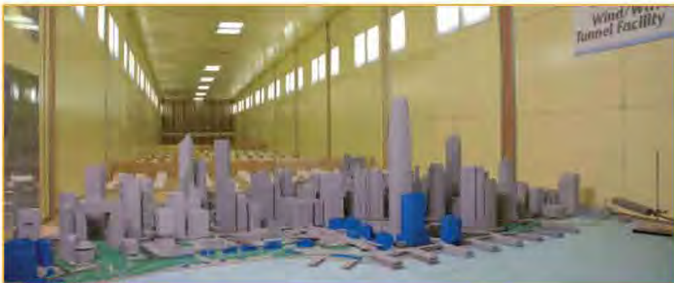
空氣流通評估風洞測試
