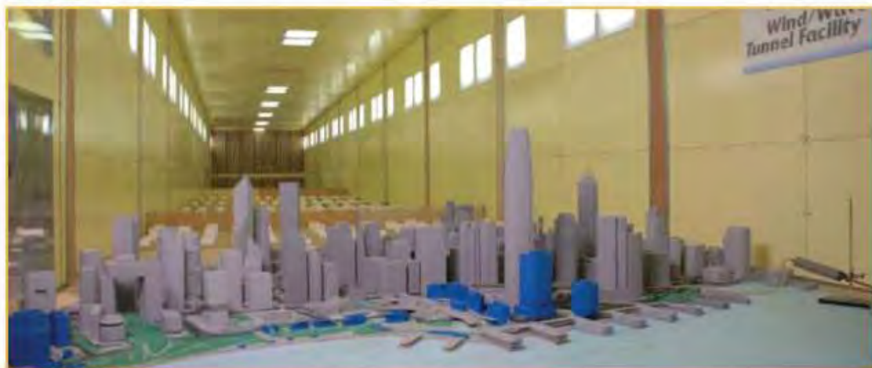
空氣流通評估風洞測試
