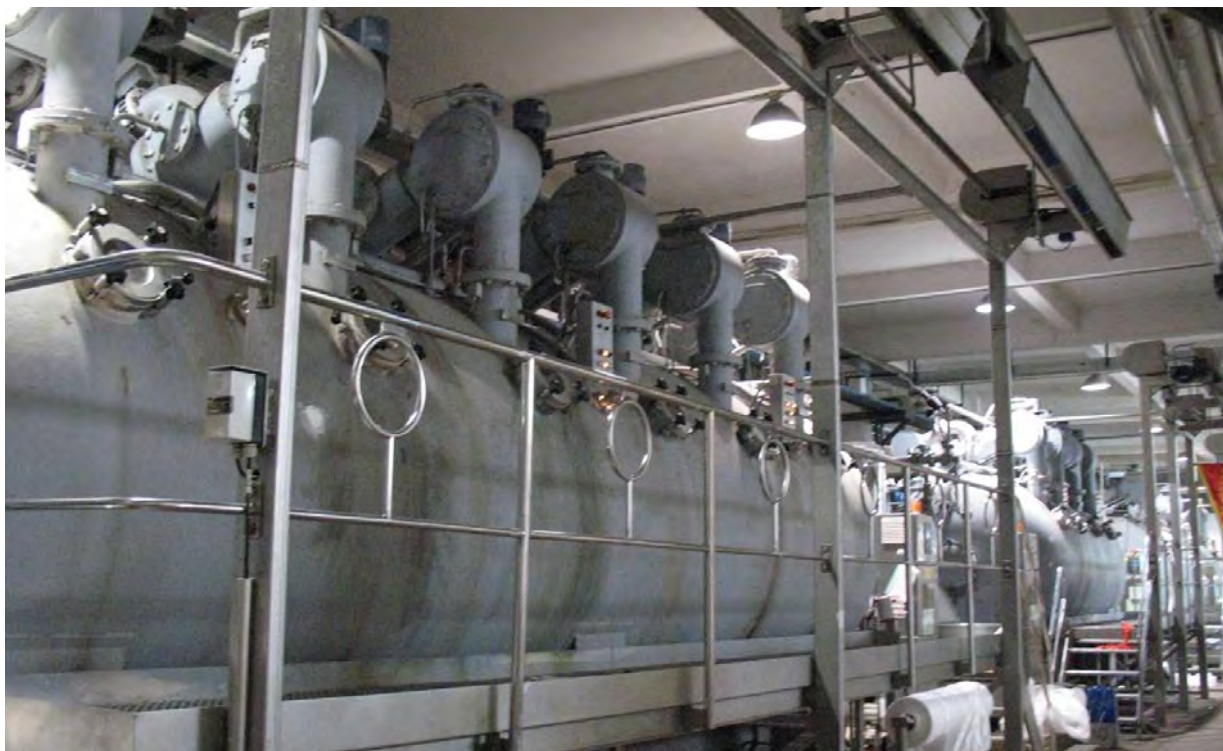
圖 3-5 「清潔生產伙伴計劃」示範項目—染缸保溫減少能耗：至2011年7月，粵港「清潔生產伙伴計劃」已經資助1469個項目，幫助企業成功實現了節能減排與經濟效益的統一。
