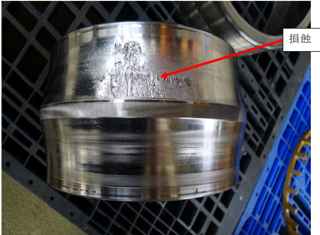
圖 5：上軸承內環的頂端滾道之損蝕
