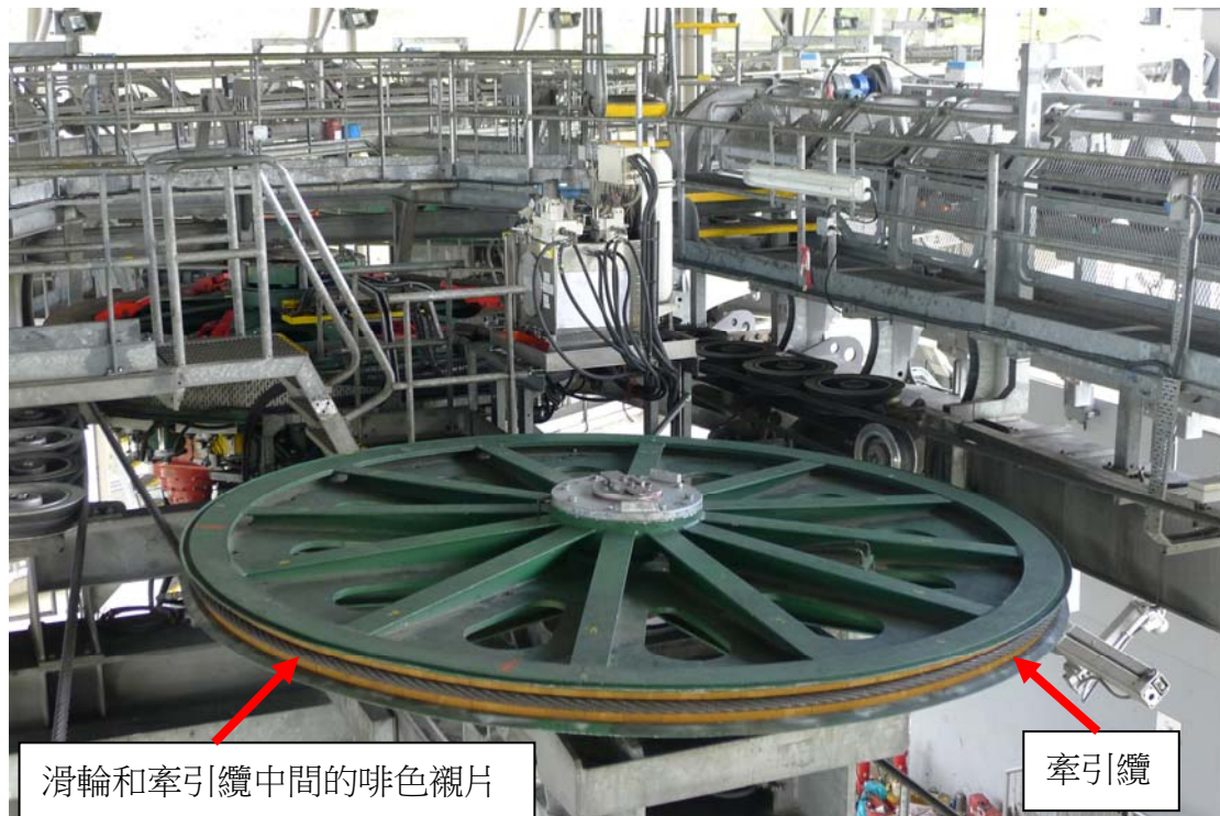
圖 4：牽引纜圍繞在 4 號滑輪 襯片上
