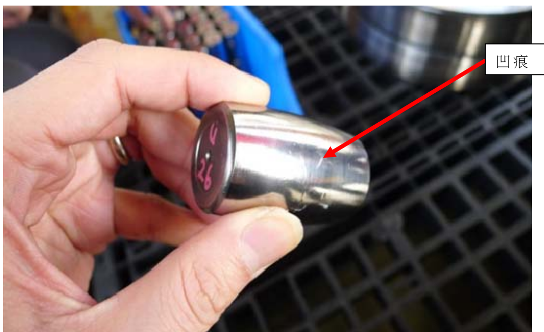
圖 7：上軸承的頂部滾柱的凹痕
