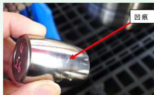
上軸承的頂部滾柱的凹痕
