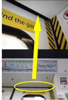
用膠條密封閃燈路線 圖設備箱後面、車門 對上空隙
