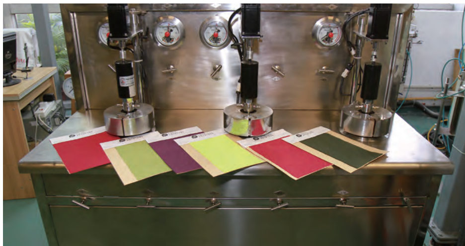
超臨界二氧化碳染色系統協助紡織業邁向綠色製造。
