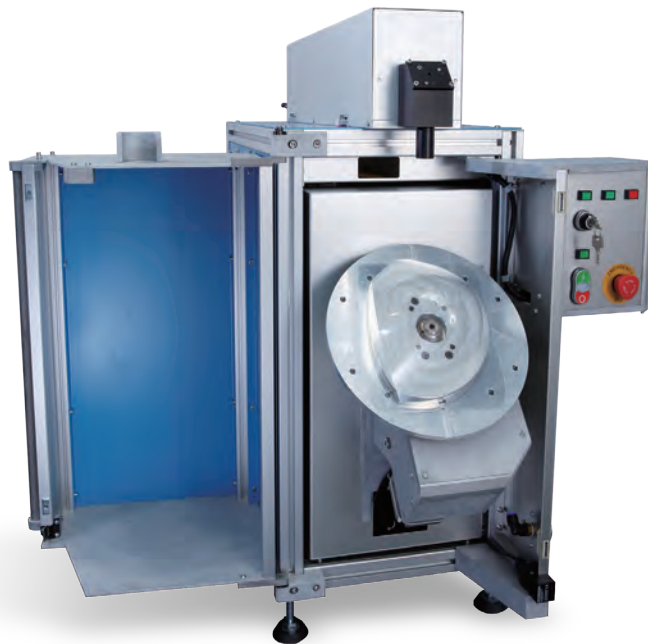
生產力局開發一套「三維胸杯膠殼激光切割系統」，精簡胸杯膠殼的製造過程並改善品質和準確度。
