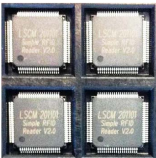
LSCM開發的 UHF Gen2 閱讀器芯片應用於移動RFID - 第一款在大中華地區設計的芯片
