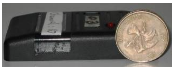
集成傳感器的RFID標籤原型
