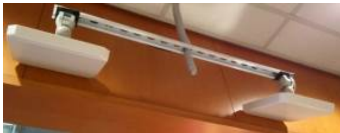
安裝在檢查站的RFID閱讀器
