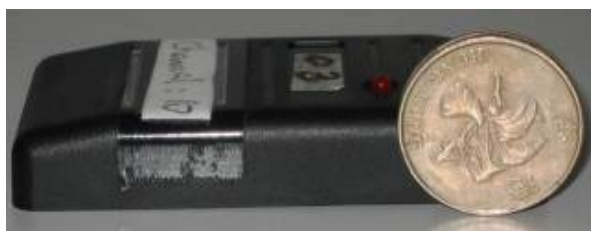
集成傳感器的RFID標籤原型
