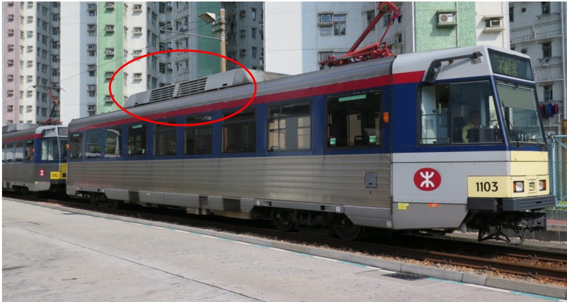
冷氣機置於輕鐵車廂頂部
