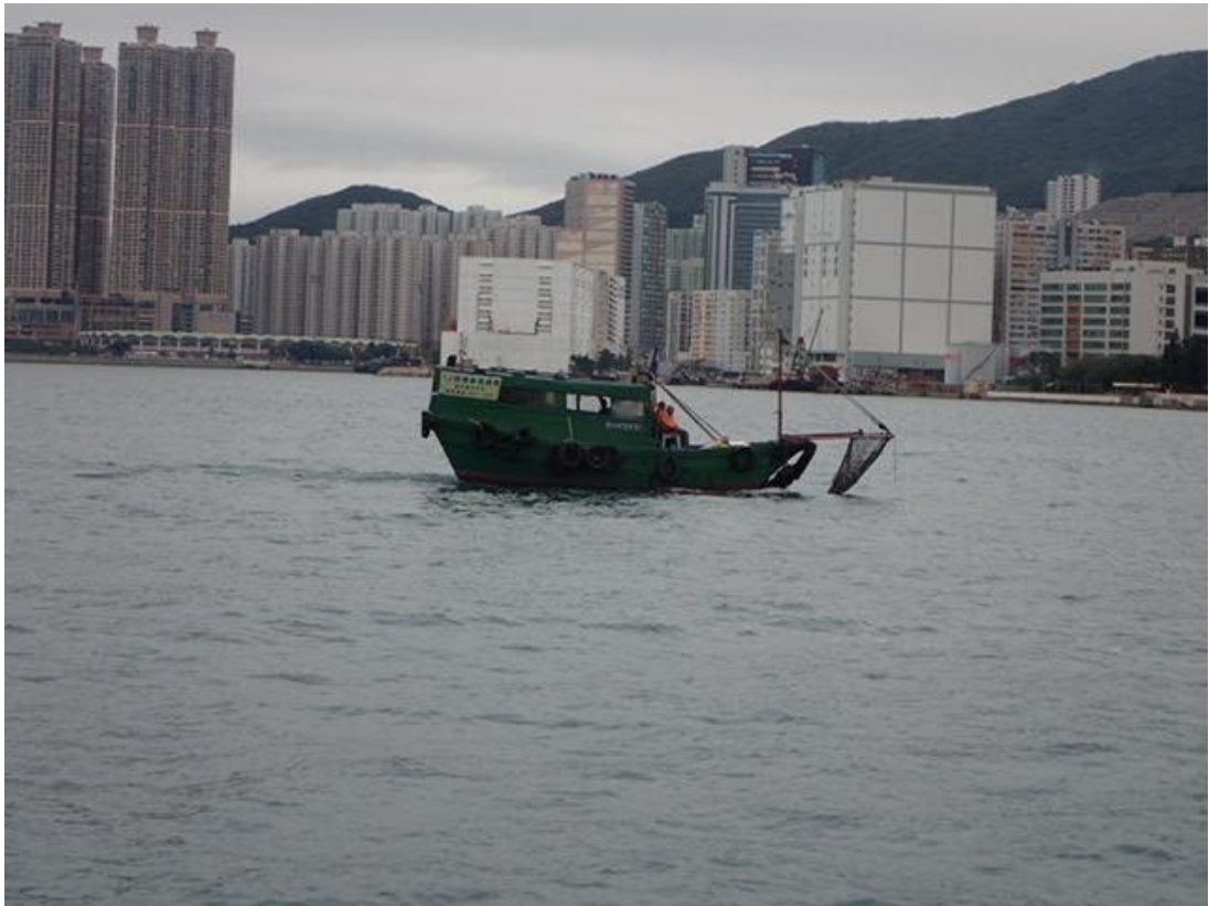
裝有垃圾網的機動木艇，適合清理在維港內或避風塘內積聚的漂浮垃圾。
