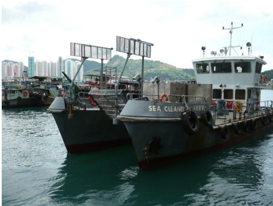
海潔級海上垃圾清理船，適合在離岸及偏遠水域工作。
