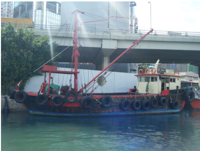
海上垃圾收集船，用以接收機動木艇所清理的海上垃圾，以轉運往垃圾收集站處理，亦可用於處理較重的海上垃圾。
