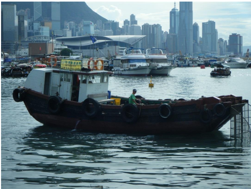
裝有機動鏟斗的垃圾清潔船隻，適合處理海上垃圾中較大型的垃圾。
