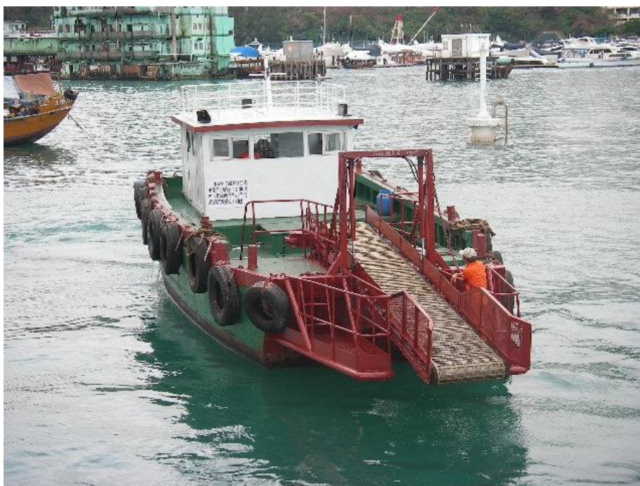
垃圾載送帶船，用作處理於海面大面積佈滿的大量垃圾。
