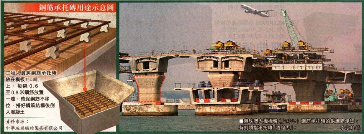
鋼筋承托磚用途示意圖
