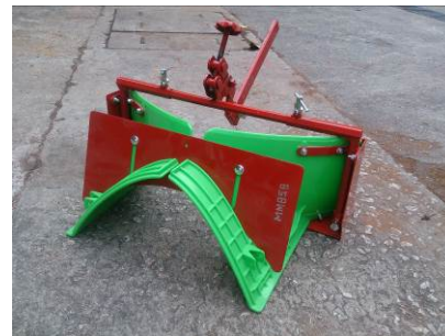
4. 起壟器 安裝於犁田機或旋耕機後方， 用於在耕作前為隆起於鬆土上 的土床定形。
