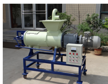
24. 固體液體廢物分離機 用於將固體從禽畜廢物中 分離出來，以提升處理效率。
