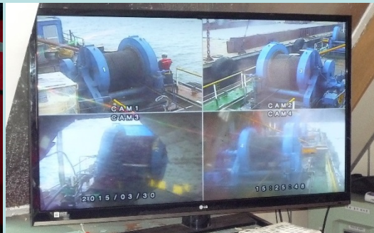
監察起錨機的閉路電視
