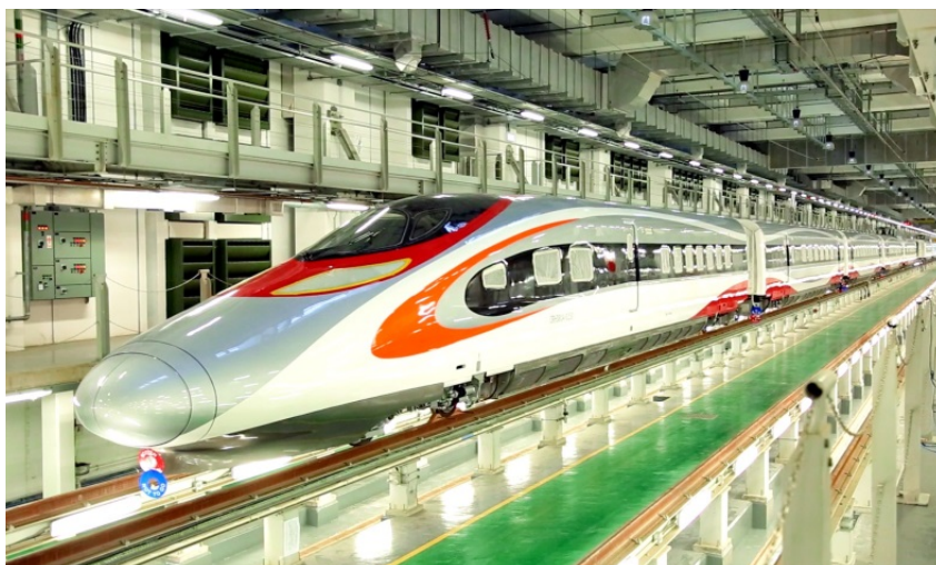
首列高鐵列車於石崗列車停放處進行組裝及測試
