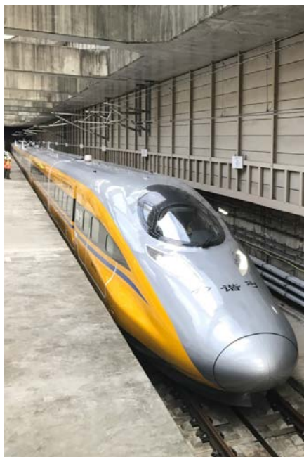
高速綜合檢測列車進行鐵路基建及系統的檢測
