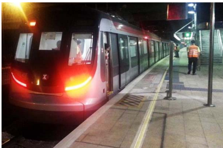
新列車於非服務時間在東鐵綫進行動態測試
