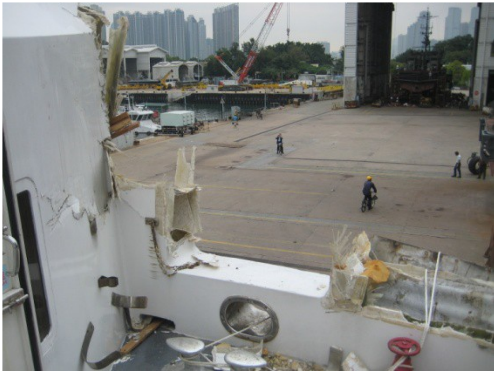
圖三：海泰號相撞部位的船體受損圖像
