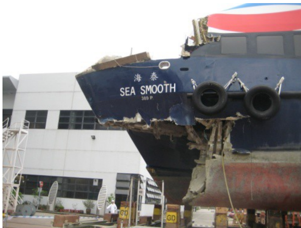
圖一：海泰號相撞部位的船體受損圖像
