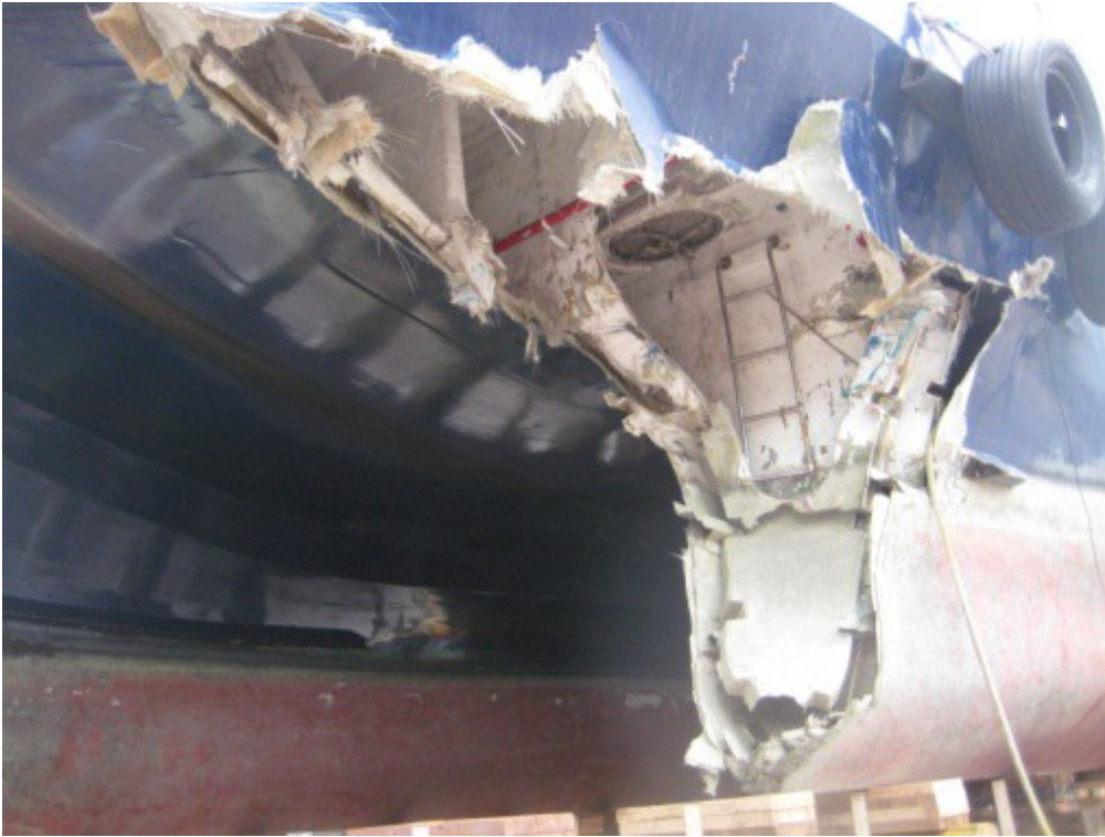
圖二：海泰號相撞部位的船體受損圖像
