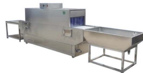
飯盒清洗設備
