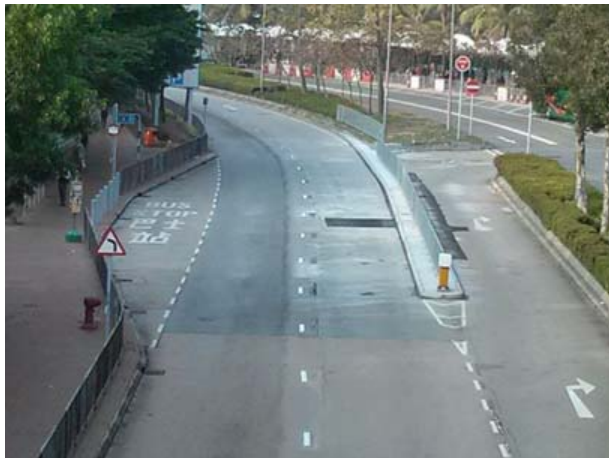
於中央分隔帶設置行人欄杆，以阻止行人在該處橫過馬路
