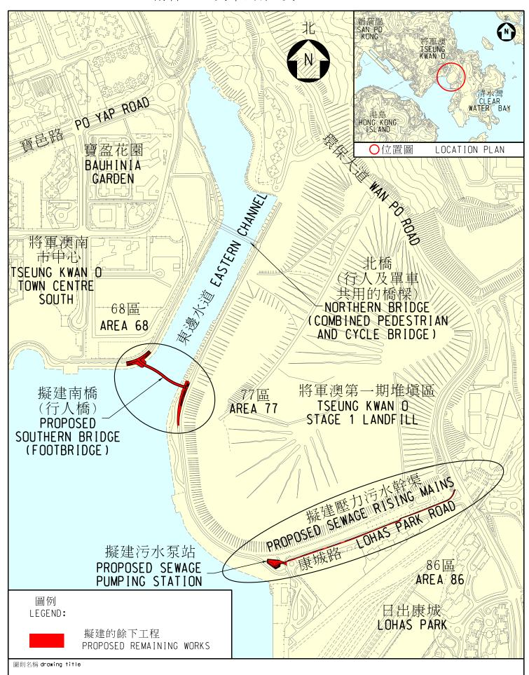
工務計劃第716CL號 - 將軍澳進一步發展 -將軍澳第一期堆填區基礎設施 - 餘下工程平面圖 PWP ITEM NO. 716CL - TSEUNG KWAN O FURTHER DEVELOPMENT -TSEUNG KWAN O STAGE 1 LANDFILL SITE - GENERAL LAYOUT OF REMAINING WORKS
