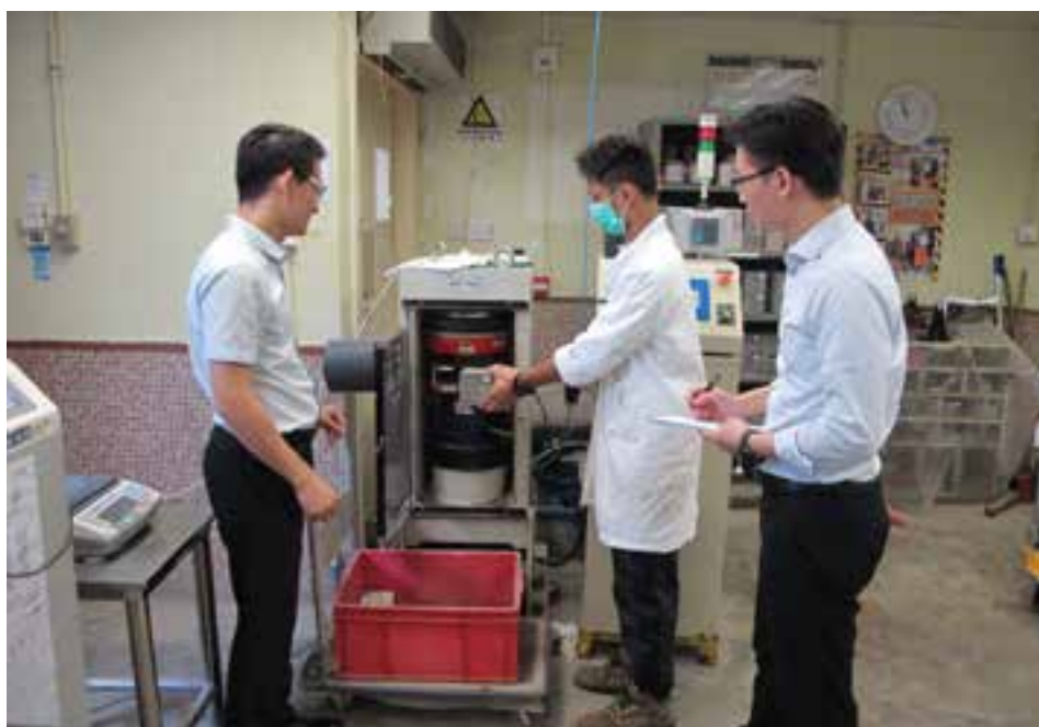
在工務試驗所檢視混凝土 壓力測試程序
