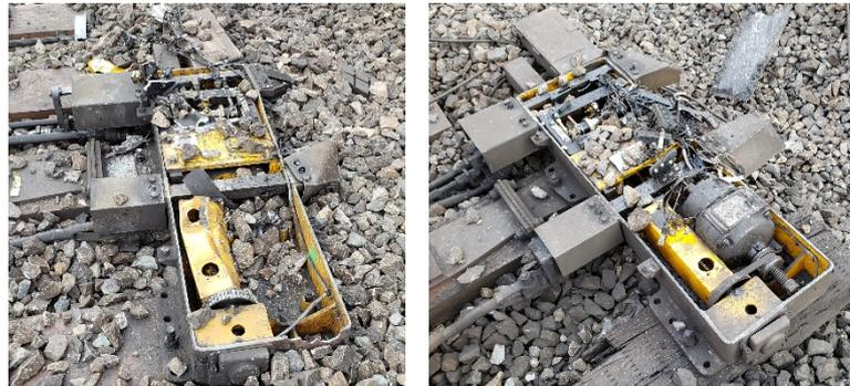
圖10：道岔 P5108(左)及 P5112(右)的轉轍器驅動機損毀
