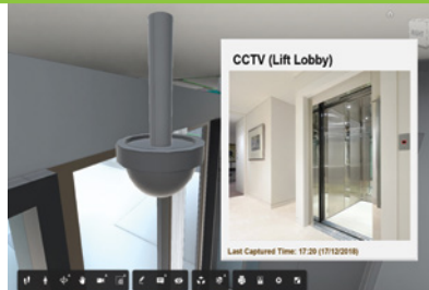
將建築信息模型技術應用至「618上海街」的物業管理，既可遙距控制項目內各項裝置，提升工作效率，亦能提示進行定期維修檢測，保持設施良好狀況。
